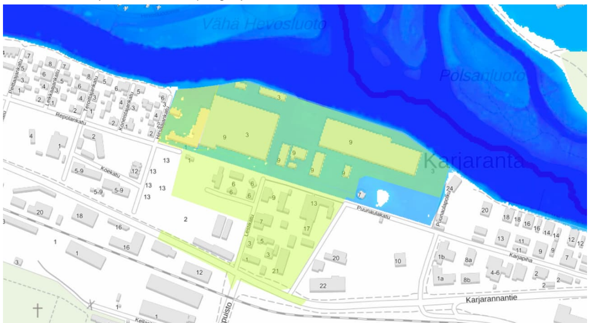
Kuva 22, tulvasuojaus tehty, vedenkorkeus +3,15 m N2000, 1/250a.
